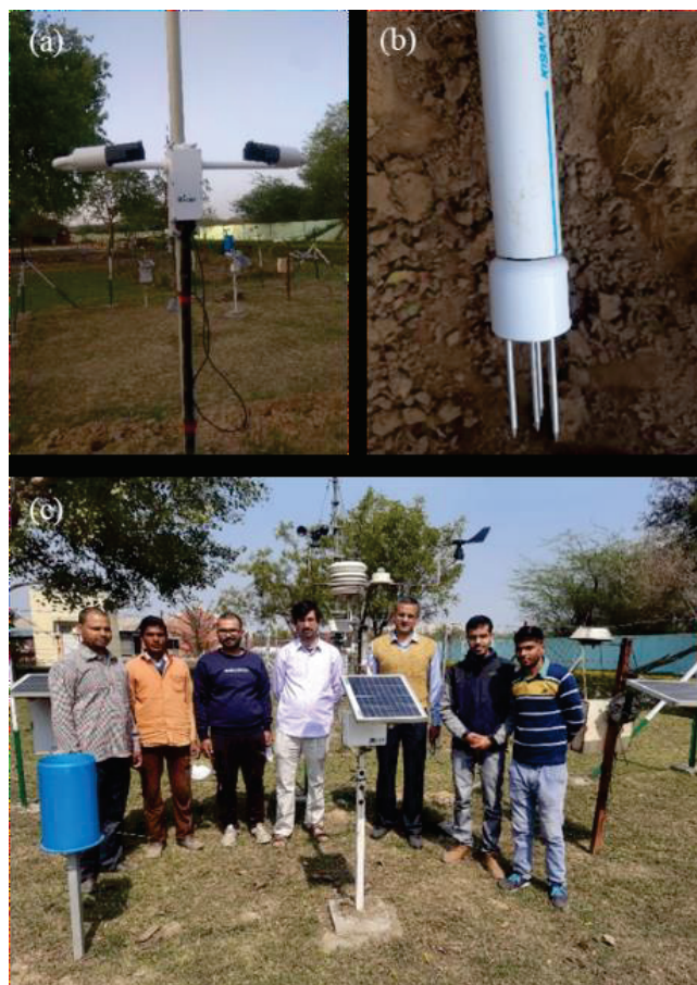
चित्र 1. आईआईटी कानपुर में स्थापित सेंसर (ए) दृश्यता सेंसर (बी) मिट्टी की नमी सेंसर एवं (सी) स्वचालित मौसम स्टेशन
