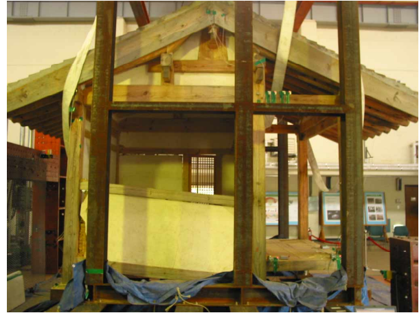
(d) Falling down of wall panels at 0.36g
